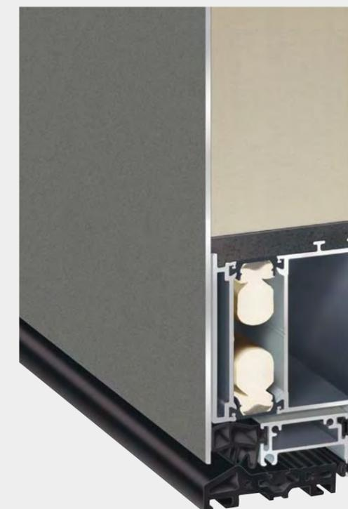
Die beidseitige Aufsatzfüllung liefert im Bereich Wärme- und Schallschutz die besten Werte. Der hoch isolierende Kern aus PU Hartschaum und Zellstoff, großvolumige Mehrkammer-Profile, spezielle Dichtungen, die äußere 3 mm und die innere 2 mm dicke Aluminiumplatte sorgen für optimale Dämmung.
